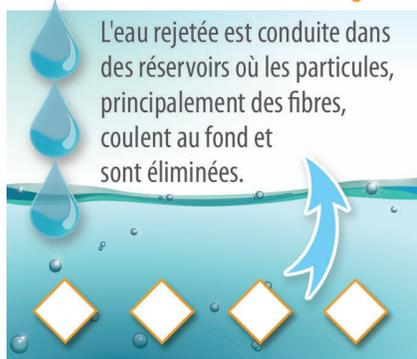
L'eau rejetée est conduite dans des réservoirs où les particules, principalement des fibres, coulent au fond et sont éliminées.
